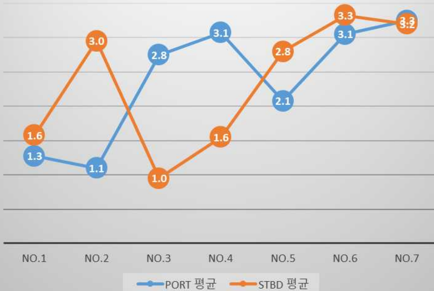
ADCS 설치 전 PORT/STBD 엔진오일 손실 평균 (24시간)
