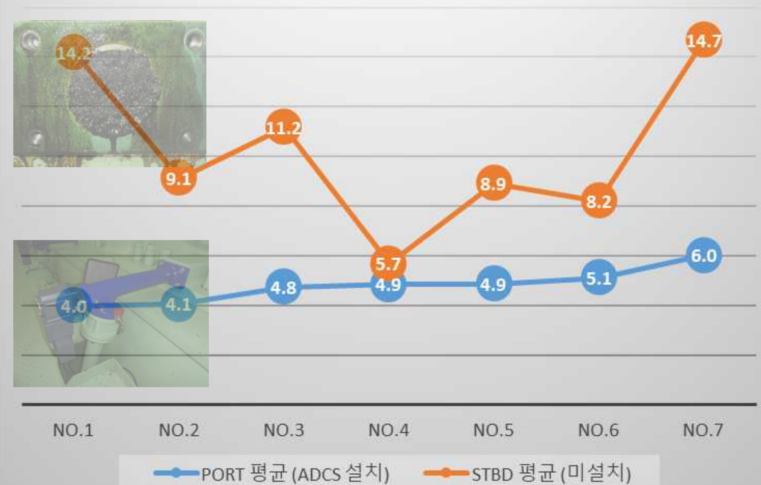
ADCS 설치 후 PORT/STBD 엔진오일 손실 평균 (24시간)
